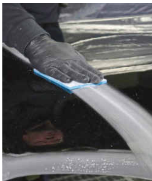
Die weiche Schaumstoffkonstruktion passt sich unregelmäßigen Oberflächen an und bietet ein ausgezeichnetes Finish, egal ob nass oder trocken geschliffen wird. (Foto: 3M)
