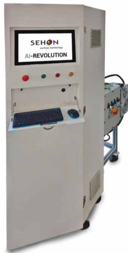
Am Steuerungsterminal der AI-REVOLUTION entscheidet der Lackierer beispielsweise darüber, welche Teile und Flächen lackiert werden sollen, und löst den vollautomatischen Lackierprozess aus. (Foto: SEHON)
