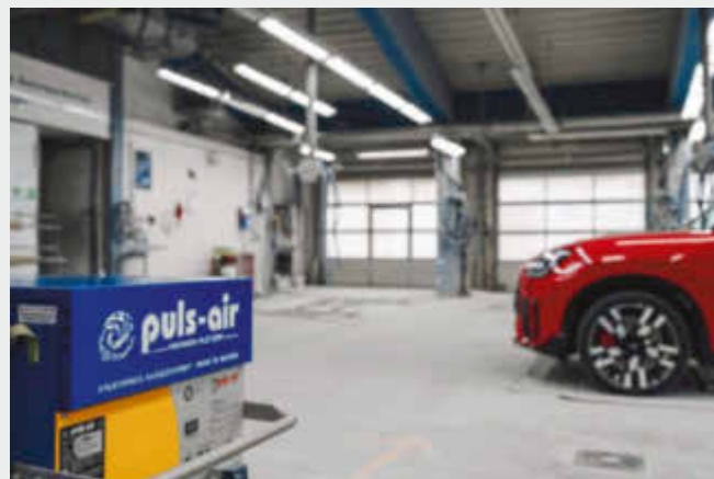
Puls-air setzt die warme Luft unten frei, diese verteilt sich, steigt auf, kühlt oben wieder ab und wird vorgewärmt immer wieder vom Gerät angezogen und zirkuliert so.
