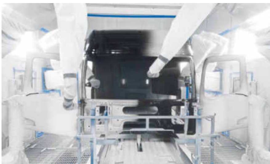
Der neue Lackierprozess im Werk Wörth macht eine Nass-auf-Nass-Applikation der Farben möglich. (Foto: Daimler Truck AG)
