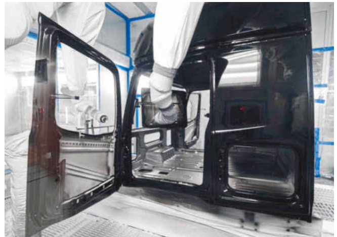
Die Außen- und die Innenlackierung im Boxenlackierkonzept erfolgen mit identischer Zerstäubertechnologie. (Foto: Daimler Truck AG)
