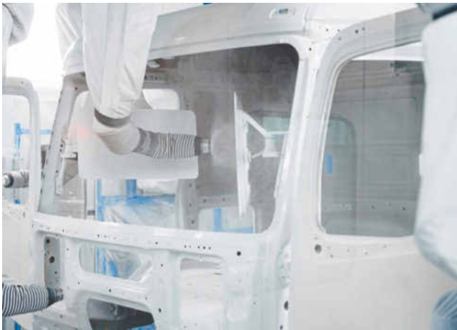
Effektives Spritzverfahren: Durch die elektrostatische Applikation wird der Overspray stark reduziert. (Foto: Daimler Truck AG)
