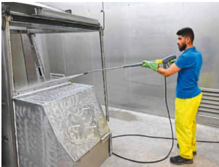
Vor dem Grundieren werden die Teile mit einer alkalischen Lösung gereinigt. Dann gelangen sie in einen Haftwassertrockner.
