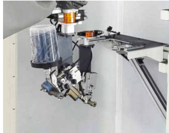
Der Pistolenport im Detail – es werden standardmäßige Hochleistungspistolen eingesetzt. (Foto: SEHON)
